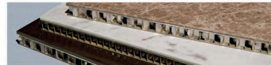
La necessità di disporre di lastre di materiale lapideo di grandi dimensioni, mantenendo però pesi ridotti, ha portato allo sviluppo di pannelli composti da una sottile lastra di pietra naturale (spessore minimo 5 mm), incollata ad un pannello di Honeycomb mediante l'utilizzo di collanti epossidici.
