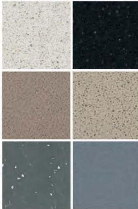
Materiale composito formato da quarzite miscelata a resina, a cui si aggiungono polveri di granito e di marmo, granulati di vetro e diversi tipi di pigmento per poter dar vita a infinite varietà di lastre. Il quarzo-resina trova il suo impiego ideale nei piani cucina e nei top bagno, ma può essere utilizzato anche per pavimenti e rivestimenti.
